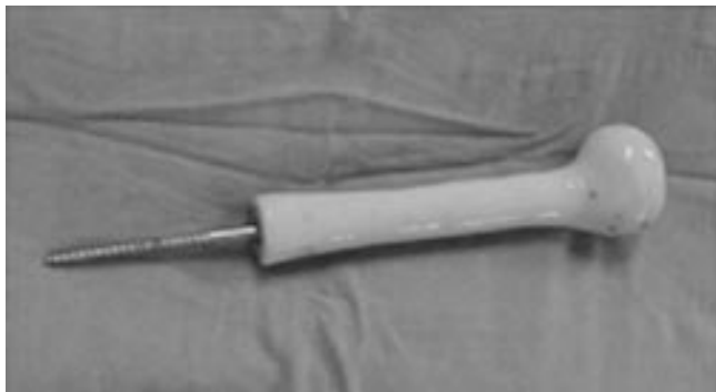
Figura 1. Prótesis de húmero elaborada en metilmetacrilato con clavo roscado de acero 316L.
