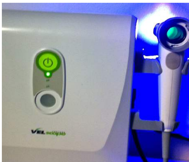
Figura 1 VELscope® emite luz fluorescente con la que se ilumina la cavidad oral; al verse a través de un filtro se pueden identificar lesiones en la mucosa oral que no se perciben con la exploración oral convencional con luz blanca.
